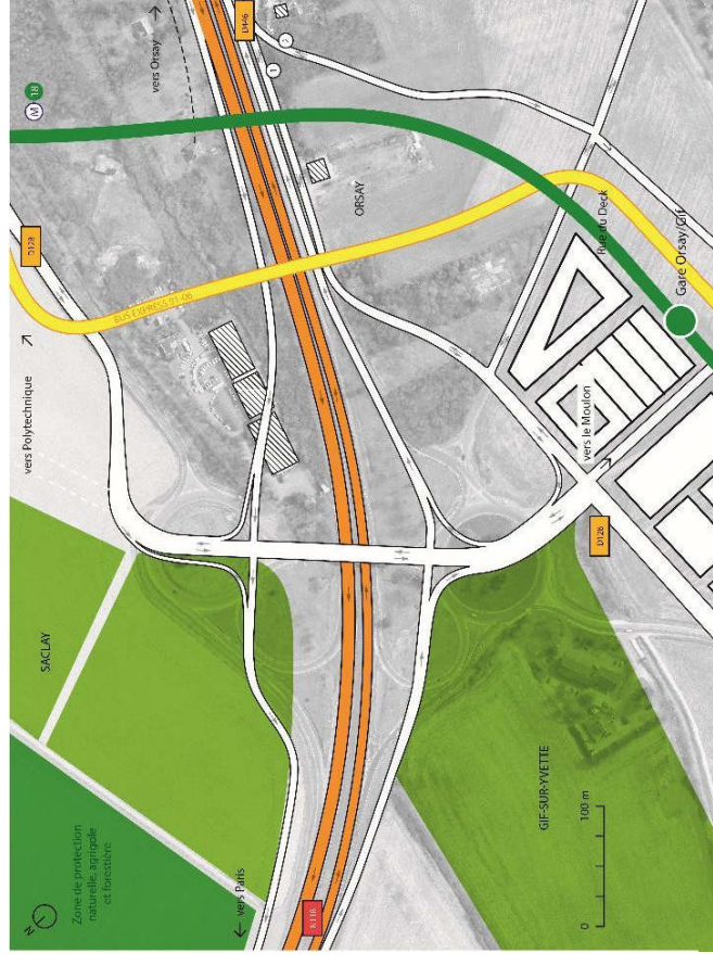
Figure 127. Configuration de l'échangeur de Corbeville envisagée dans le cadre du scénario n°2. (NB : deux solutions alternatives – 1 ou 2 – sont également montrées pour le rétablissement de la route de Versailles)
